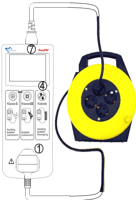
Figuur 9: Testen Verlengkabels / Haspels
