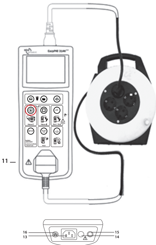
Figuur 8 Testen van verlengsnoeren en haspels
