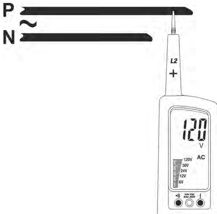
Fig. 5: Détection de Tension CA avec 1 fil
