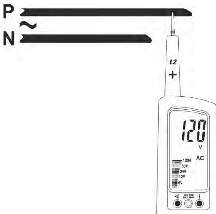
Fig. 5: Deteção de tensão AC 1-fio
