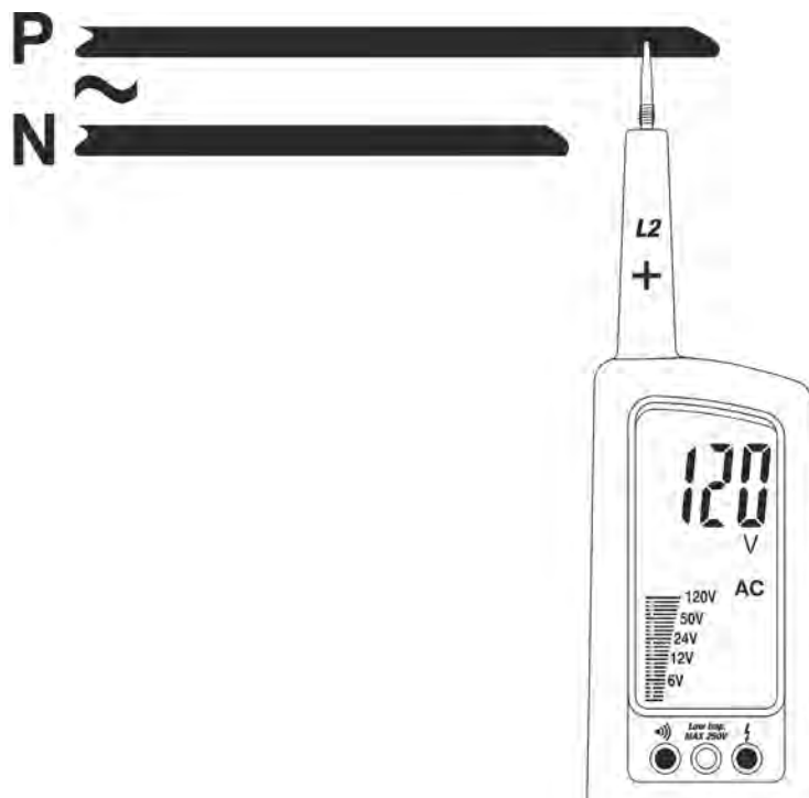
Fig. 5: Misura di Tensione AC a 1 filo (polarità)
