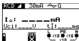
Figuur 33 Menu meten uitschakelstroom
